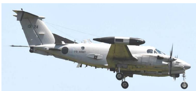
8月6日 米陸軍の電子情報収集機 RC-12X (ガードレール) が飛来。 電子情報収集のためのアンテナを 多数設置した変わった機体
