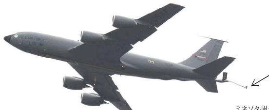
海軍、海兵隊機(主に 戦闘機)に給油する時 には、フライングブーム 先端にドローグホースを 取り付けます。
