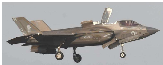
短距離着陸モードで着陸 エンジンノズルを下方に向けるので爆音大きい
