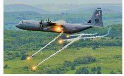
遺失物の形状等 ○フレア本体は飛行中に分解し充填物が落下しました。 ○フレア本体は円柱状の形をしており、充填物はその本体の中に入っています。フレアの充填物は、錆びた金属片のように見えます。充填物の大きさ、長さ約30~33 cm、重さ約130gです。 ○フレアとは航空機の防御に使用されるものであり貨物として搭載するものではなく、機体外部に取り付けるものです。 ○落下した充填物は、有害物質であり、持ち上げたり触れたりすべきではありませんが、そのまま放置されている限りは自然発火の危険性はありません。また地上に落下した場合の土壌汚染はなく、水中に落下した場合も水質汚染はおきません。(写真:ドイツ・ラムシュタイン米空軍基地でフレアを発射している様子。米空軍 HP)
